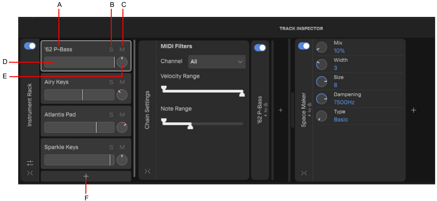
A. Instrument name B. Solo C. Mute D. Volume E. Pan F. Add instrument to rack
